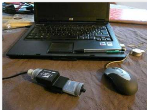
Photo 8 : lecture et transfert des données des sondes par un coupleur infrarouge/usb
